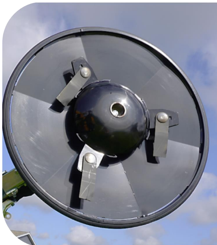
Rotor à lames en acier trempé
