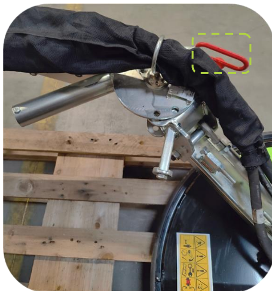
Broyeur sous clôture RI en position déployée et déverrouillée (position de travail).
