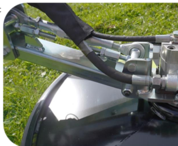
Suspension réglable sur broyeur sous clôture RI
