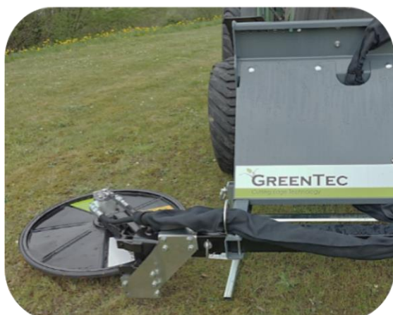
Multiporteur FOX monté avec broyeur sous clôture RI en position de travail. Le système de bras du multiporteur permet d'étendre la portée de l'outil de travail.
