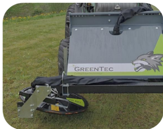
Multiporteur FOX avec broyeur sous clôture RI en position de transport. L'outil de travail est orienté vers l'intérieur du véhicule, pour une sécurité maximale en conditions de circulation.
