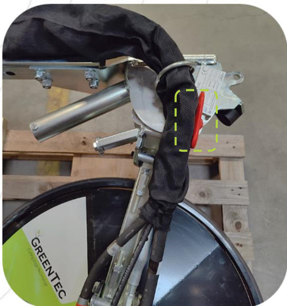
Broyeur sous clôture RI en position rétractée et verrouillée (position de transport).
