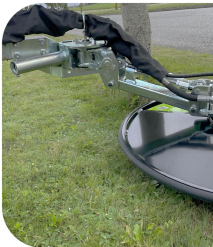
Système de bras à ressort/fonction de « sécurité »
