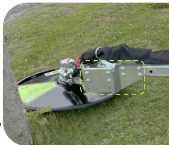
Exemple de support de base pour RI 62-82 ↔ Multiporteur FOX
